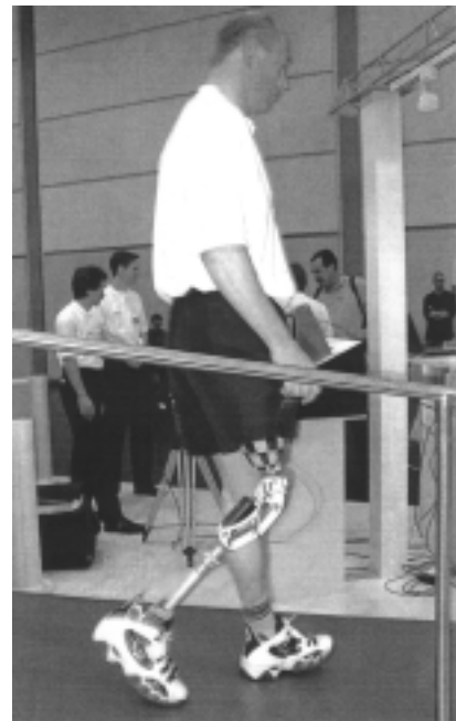
図 10 M R 流体制御膝継手: ドイツ BiedermannOtech 社
