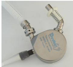
磁気軸受遠心型 テルモ社 Duraheart
