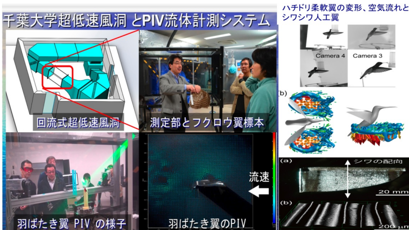
図2 生物飛行統合力学シミュレータ，超低速風洞・DPIV 計測システム及びハチドリ規範型飛行ロボット
