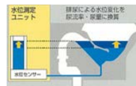
(2) 水位測定し溜水量変化に換算
