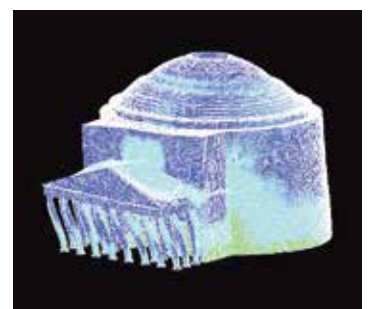
バンテオンの地震応答解析(変形を2000倍に誇張) ／ADVENTUREプロジェクト
