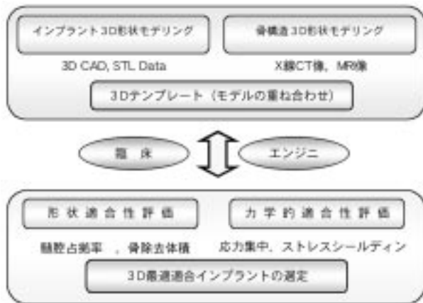
図8 デジタルモデルを用いた適合インプラント評価システム
