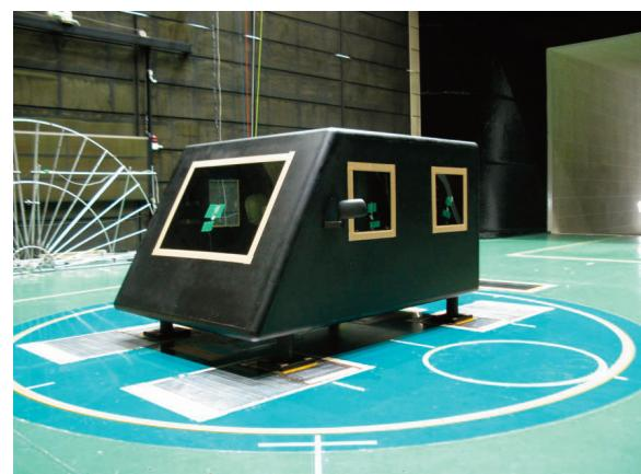
図2 車内騒音評価用簡易車両モデル
