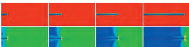
図4 き裂進展計算（上：フェーズフィールド、下：相当応力）
