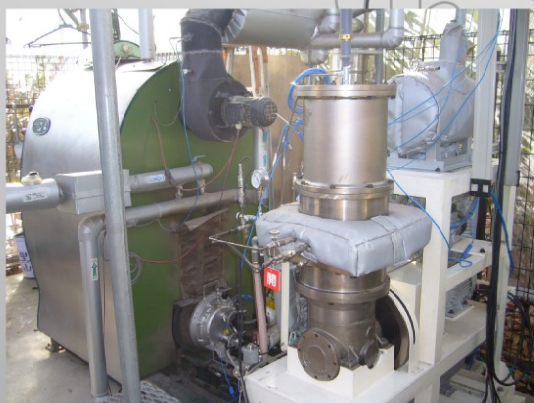
AP1-1/250 1kW級低温度差型間接加熱式 スターリングエンジン 大阪万博記念公園 (2008-2021)
