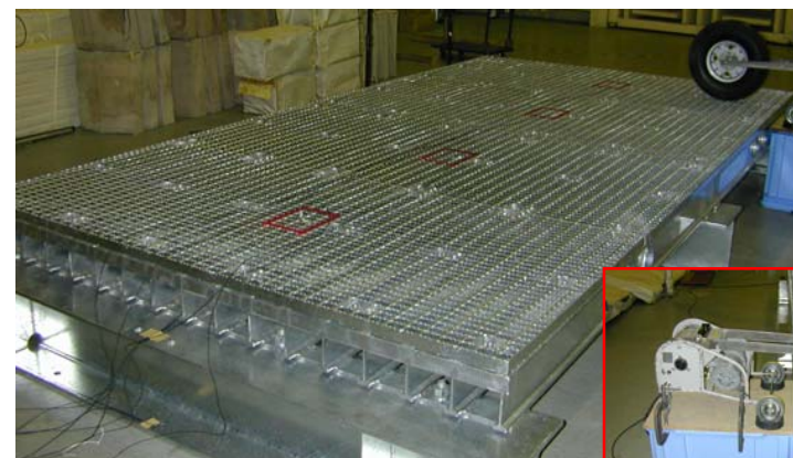
グレーチング床版供試体 (半無響室内で実施)
