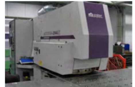
タレットパンチプレス 冷間圧延鋼板SPCC 板厚1.6mm
