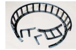
円すいころ軸受 保持器 主原因) 過大モーメント荷重、 潤滑不良、異物噛み込み
