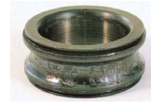
深溝玉軸受 内輪 主原因)過大アキシャル荷重
