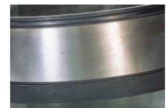
円すいころ軸受 内輪 主原因) 異物噛み込み
