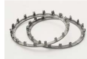
自動調心ころ軸受 保持器 主原因) 過大モーメント荷重、 潤滑不良、異物噛み込み
