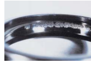
アンギュラ玉軸受 外輪 主原因)取扱不良
