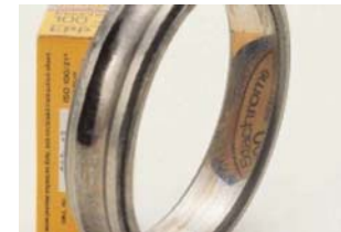
深溝玉軸受 内輪 主原因) 締め代不足
