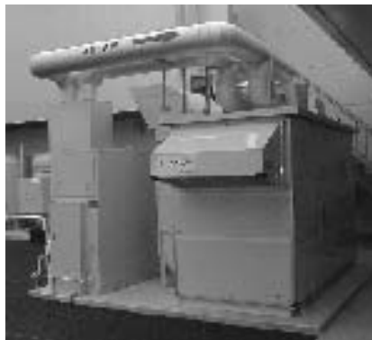
図2 MGT排熱利用型デシカント空調システム
