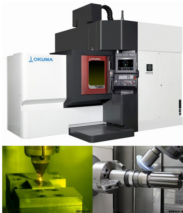
図8 金属積層造形が可能な複合加工機の例（オークマ株式会社製） 上：加工機の外観，左下：積層造形の様子，右下：研削加工の様子
