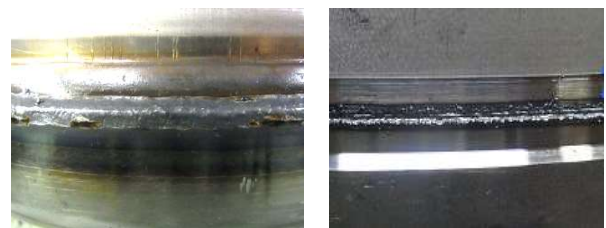
アーキ溶接外観
