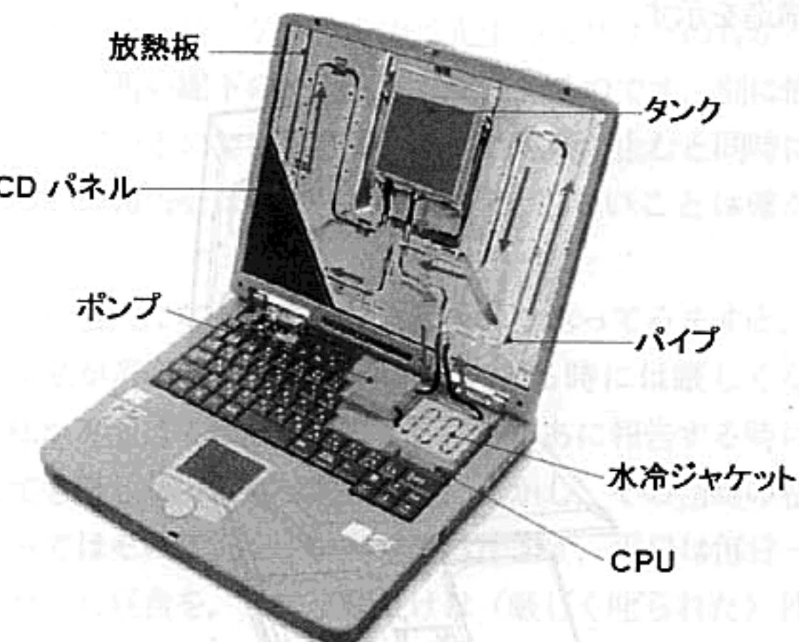
図1 水冷システム搭載ノートブック型PC
