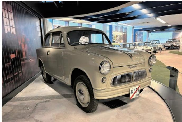
スズライトは、鈴木自動車工業(株)(現スズキ(株))の創業者鈴木道雄の指導のもと、鈴木三郎を中心にして、ドイツのロイト自動車工業のロイトをモデルとして開発した軽四輪自動車である。1954(昭和29)年に試作車を製作し、箱根での登坂テストで判明した不具合を改良してスズライトSSを完成させた。
