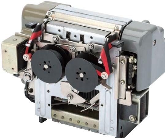
EP-101は、腕時計を製造していた(株)諏訪精工舎(現 セイコーエプソン(株))が、子会社の信州精器(株)とともに、1968(昭和43)年9月に製造・販売を開始した電子式卓上計算機(電卓)用プリンターである。フライングドラム方式と呼ばれる方式で、数字と記号の活字を紙に印字する。
