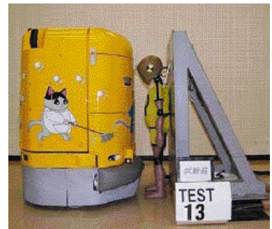
図5 清掃ロボットによる衝突試験
