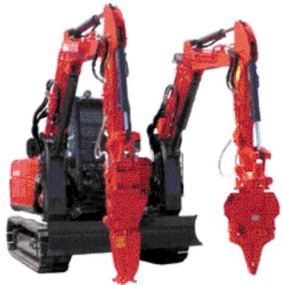
図1 双腕作業機ASTACO（7t級）
