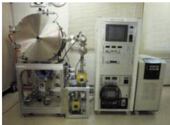
図2 新開発の双極子プラズマ装置
