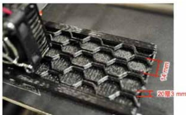
図3 CFRPプリントの様子と造形例
