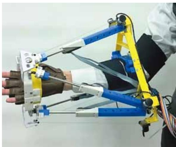
図2 パラレルリンク式アシストロボット
