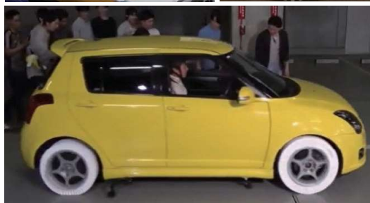
図3 折紙ハニカムコアタイヤの製作と実車試験 (明治大学と日本工学院のコラボレーション)
