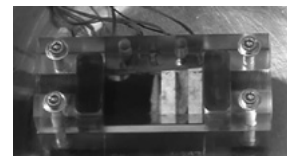
試作したポンプ (黒インクで流れを可視化している)
