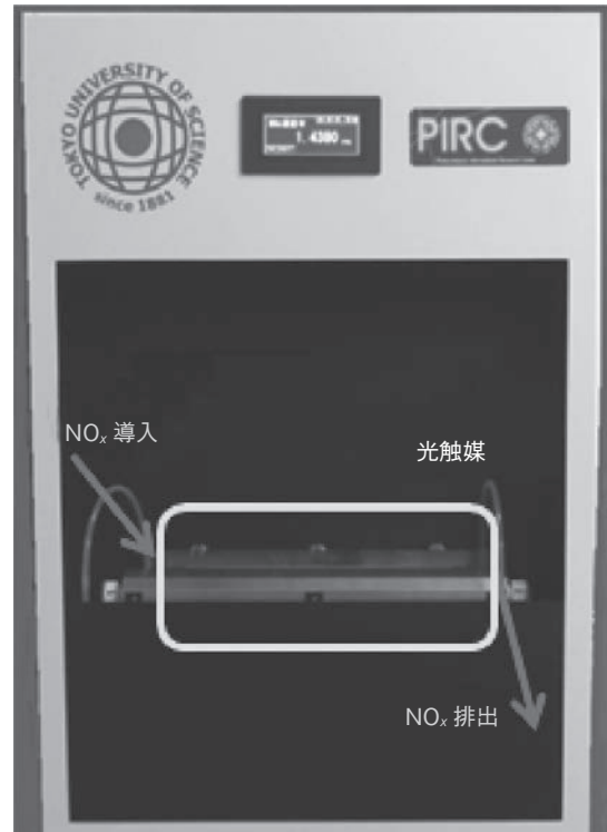
図2 光触媒を通して排気ガス中の窒素酸化物( \text{NO}_x )を中和する試験機。装置上部のディスプレイには \text{NO}_x 濃度が映し出されている。
