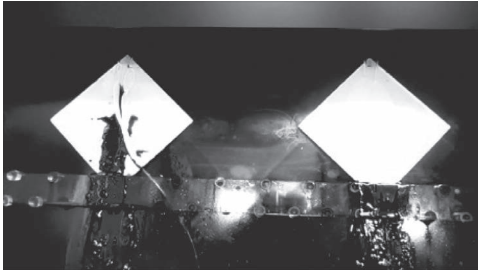
図1 通常のタイル（左）と光触媒コーティングされたタイル（右）に汚れを付けて水で流す実験。光触媒でコーティングされた方は汚れが簡単に落ちる。
