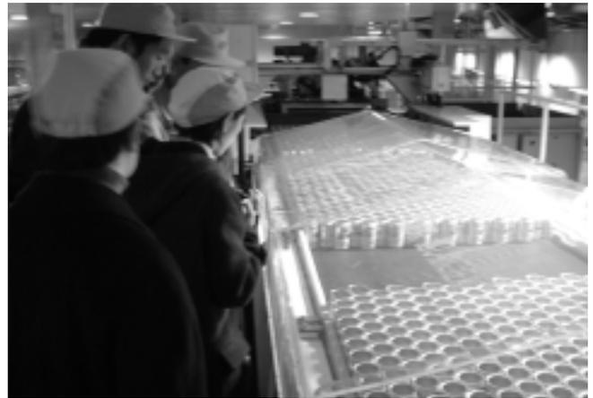
図4 幅広いコンベアによって空の缶が搬送されている
