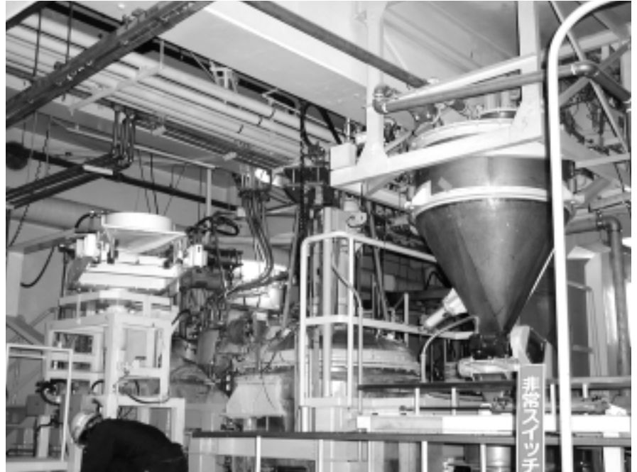
図3 乳剤を混ぜ合わせる釜（右側）
