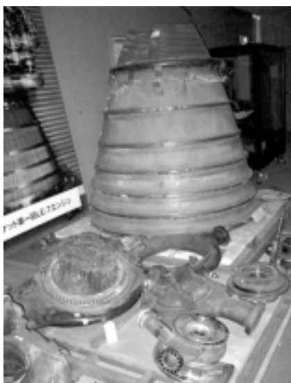
図6 小笠原の海底から引き上げられたH-II ロケットの第1段エンジン「LE-7エンジン」
