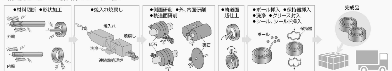
図 2 ベアリングの製造工程〔提供 日本精工(株)〕
