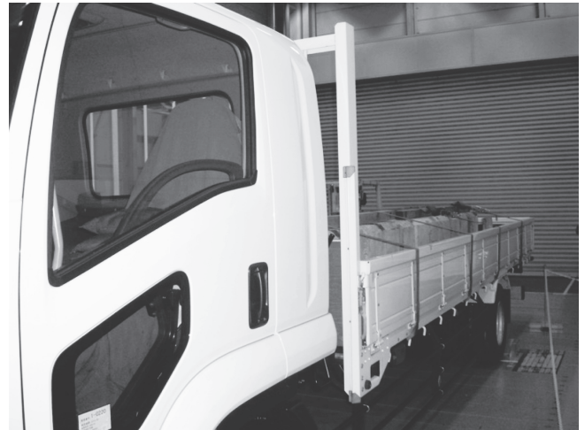
図3 ロードシミュレータ（車輪下にアクチュエータが設置されている）
