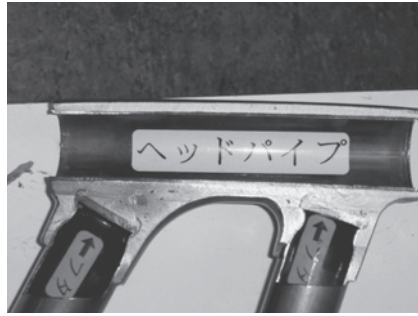
図4 ダイカスト製法による接続部(断面)
