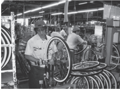
図 10 車輪の調整 最終調整は人の手でやる
