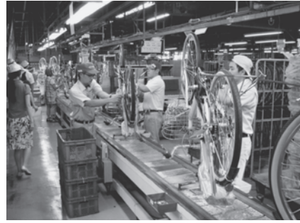
図7 コンベアによるライン生産
