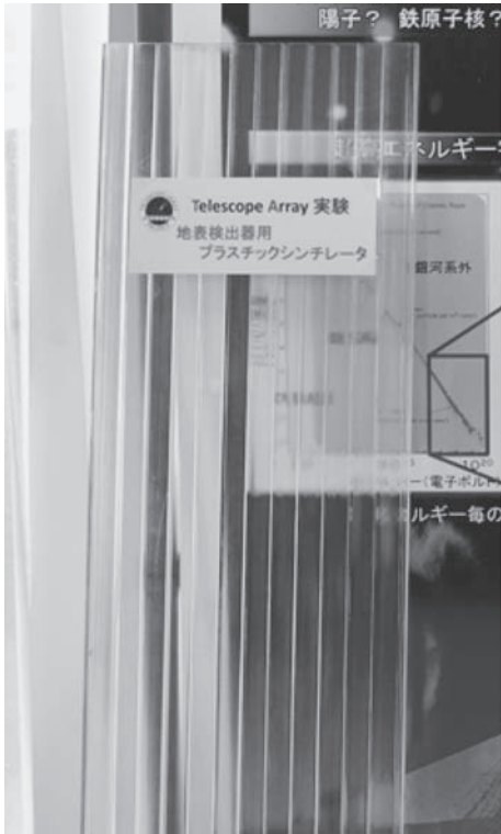
図1 テレスコープアレイ実験で使われるプラスチックシンチレータ
