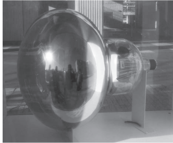
図5 スーパーカミオカンデに取り付けられている直径50cmの光電子増倍管
