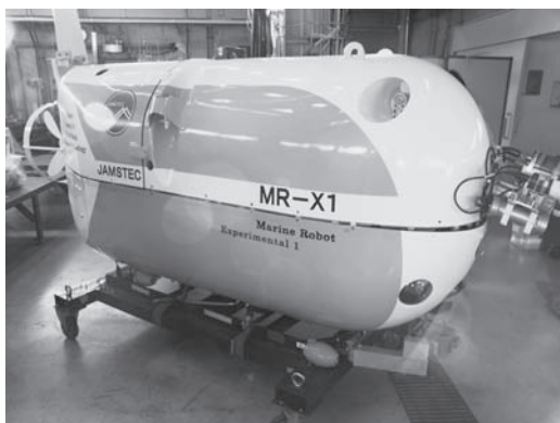
図10 作業型自律探査機「MR-X1」
