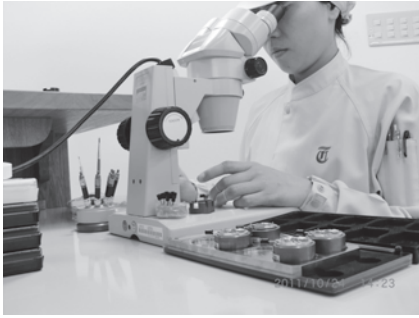
図3 ムーブメントへ注油を行う職人
