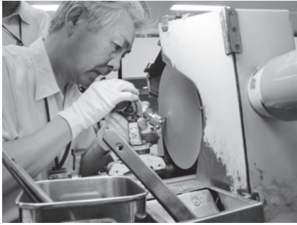
図8 時計ケースの研磨を行う職人
