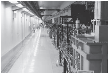
図9 加速器棟 上流部内部 (手前が電子銃, そこから加速管が奥までつながっている)
