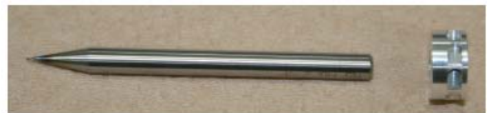
図2 小径エンドミルとタービンバケット部品
