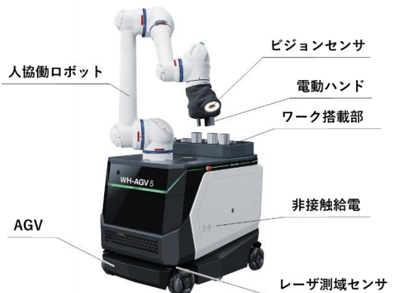
図1 WH-AGV の構造
