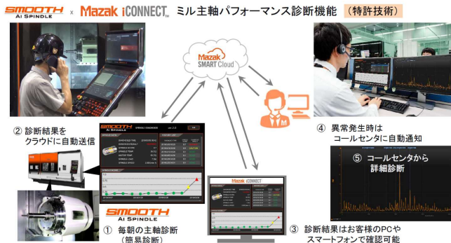
図2 ミル主軸パフォーマンス診断
