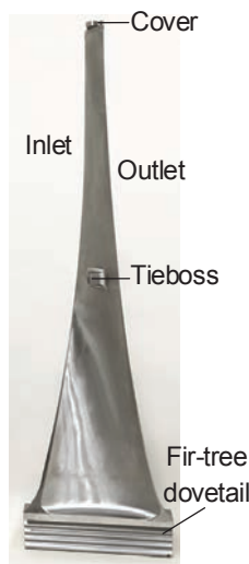
図2 最終段動翼 (翼長 1219.2mm)
