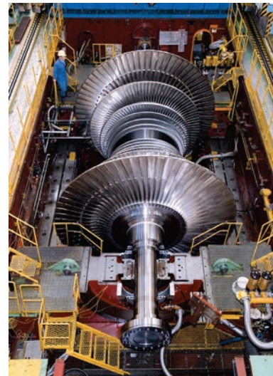
図6 実機大蒸気タービン回転試験装置
