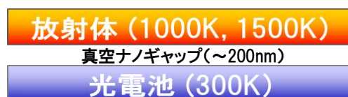
図 5 GaSb 半導体近接場光発電システム
