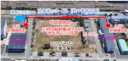
図5 超電導ケーブル敷設状況
