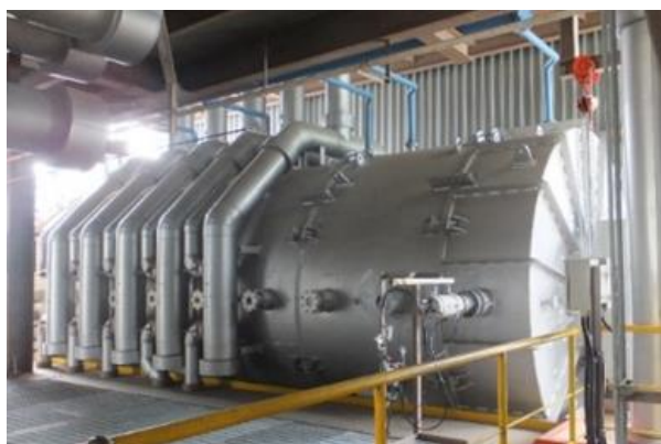
図 2 大型燃焼試験炉
