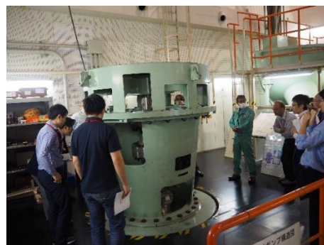
原子力保安研修所・1次冷却材ポンプ軸封部モックアップ前にて
