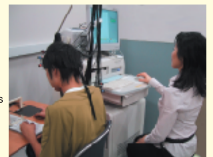
図1 脳血流量を測定する光トグラフィーを用いて, 鏡に逆さまに映った星型図形をなぞるといった複雑な課題を行っているときの脳活動を測定している様子
