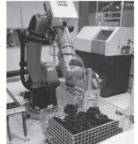
図2 鋳物素形材ピッキングシステム
