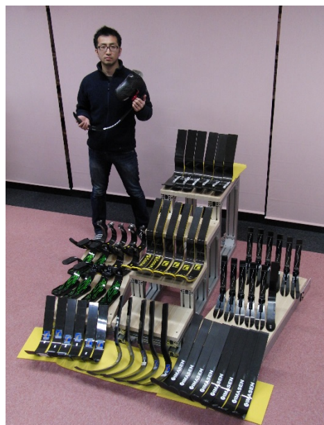
図1 国内外での使用される競技用義足の板バネ
