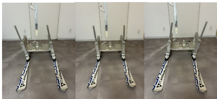
図4 チェアスキーの角付と座面のスライドの様子
