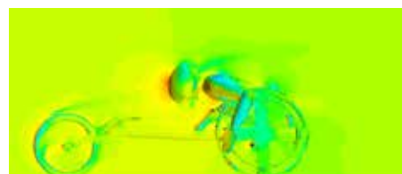
CFDによる車いすマラソンの空力解析結果例 (7)
