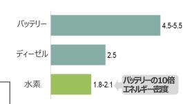
パワートレインパワートレイン重量比較:トン (セミトラックの18トントラクターユニット)
