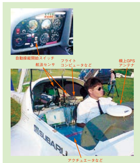
図3 自動飛行システムの構成
