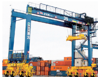
トランスファクレーン (RTG)
