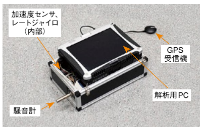
図1 試作したプローブシステム
